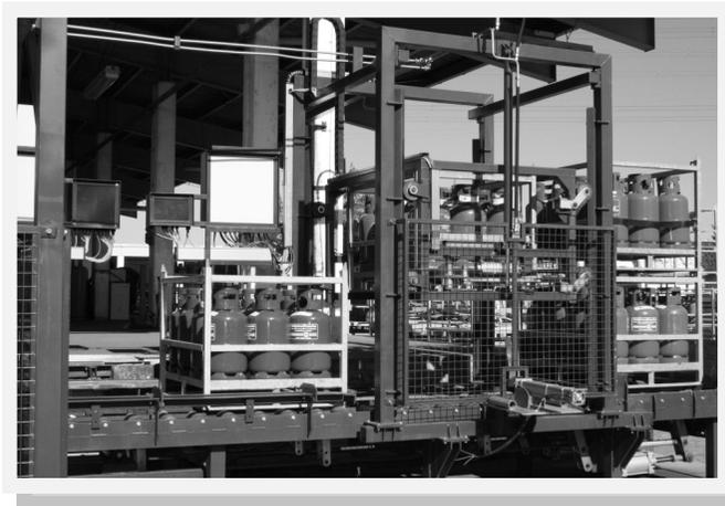
RG-Power+<sup>3</sup> Flaschen werden in rostfreien, stapelbaren Transportgitterboxen ausgeliefert.
